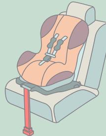
Es necesario confirmar que este dispositivo no se coloque sobre un suelo con compartimento inferior, pues restaría eficacia y por tanto pérdida de seguridad de la sillita.
